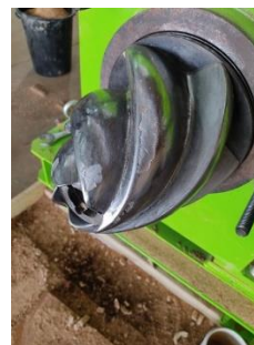
混入したネジと 損傷した部品
