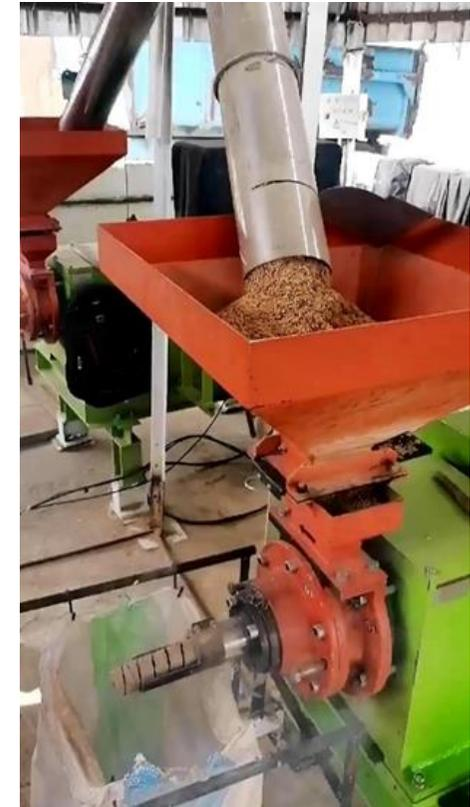
セネガルで稼働している粉殻燃料製造機械(2022 年)森真一
