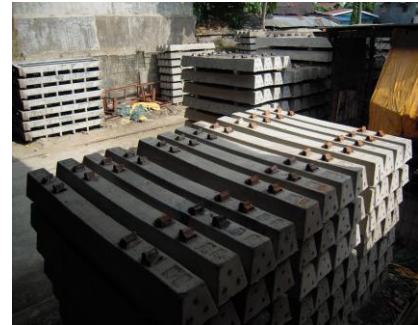
ナガ駅に隣接する工場で製造され、積み上げられたコンクリート枕木。
